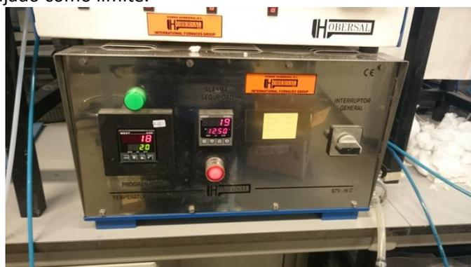
**Figura B.21.** Sistema de control de temperatura del horno utilizado en los experimentos de reactividad.
