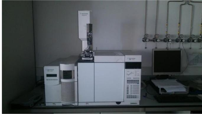
**Figura B.17.** Cromatógrafo de gases acoplado a un espectrómetro de masas de la sección de análisis de los PAH.
