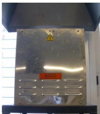
**Figura B.20.** Horno Hobersal utilizado en los experimentos de reactividad.
