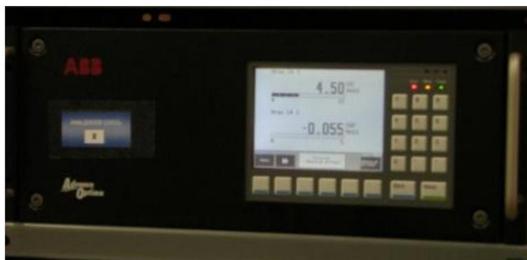
**Figura B.22.** Analizador de  $CO/CO_2$  de la sección de análisis de gases.
