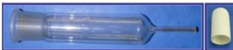
**Figura B.10.** Portafiltros y filtro de la sección de recogida de hollín.
