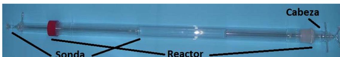
**Figura B.6.** Reactor de pirólisis con cabeza soldada y sonda.
