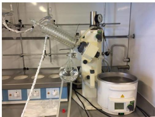
**Figura B.16.** Rotavapor de la sección de concentración de los PAH.
