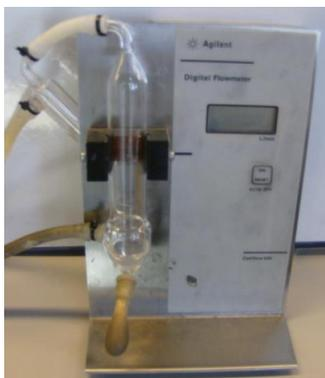
**Figura B.4.** Burbujímetro digital.
