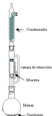
**Figura B.15.** Esquema de una extracción Soxhlet.
