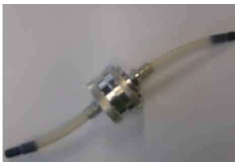
**Figura B.12.** Portafiltros con filtro en su interior de la sección de acondicionamiento.
