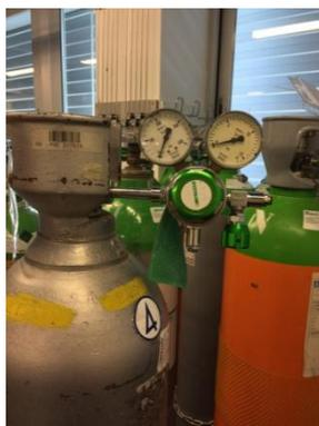
**Figura B.1.** Manorreductor con indicador para botella de gas.
