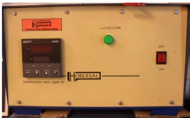
**Figura B.9.** Módulo de control del horno.
