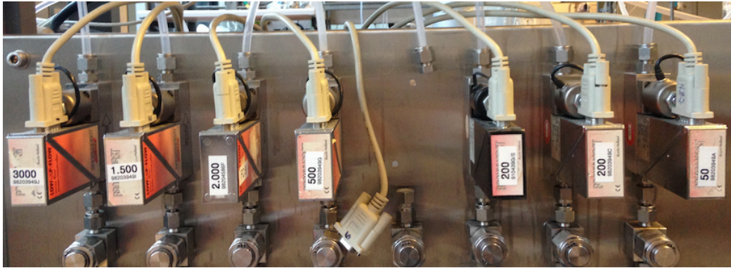
Figure B.2: controladores de flujo másico utilizados, los valores están en NmL/min, de derecha a izquierda están conectados a: 3000: nada; 1500: N_2 dilución; 2000: SO_2 calibración; 500: nada; 200: N_2 reactor; 200: O_2 reactor; 50: SO_2
