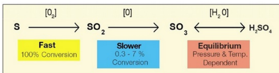
Figura 2.10: resumen de la oxidación de azufre durante la combustión. [27]
