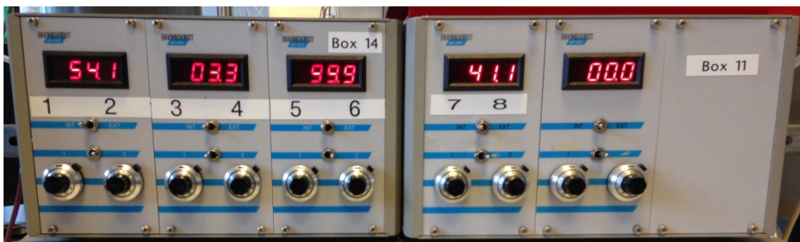
Figure B.3: controladores manuales. La válvula del controlador de flujo másico se abre con la ruleta negra y los números en rojos es el porcentaje de apertura de éstos.
