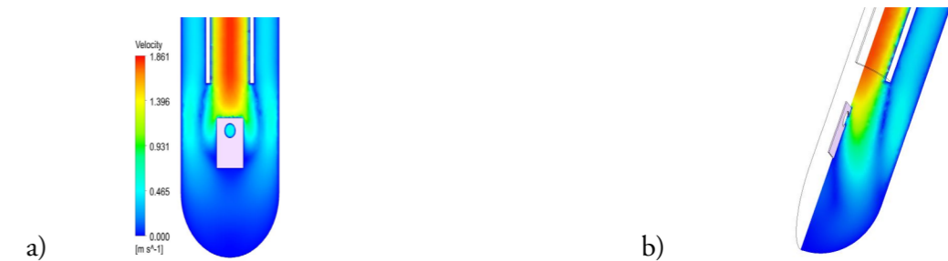
Figura 19.- P_sd, Campo de velocidades de: a) plano frontal y b) plano transversal del dispositivo. Q 524 mm 3 /min.
