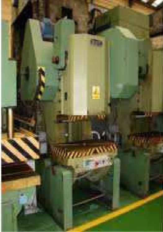
Figura 9. Prensa excéntrica BELT mod. BREN 80
