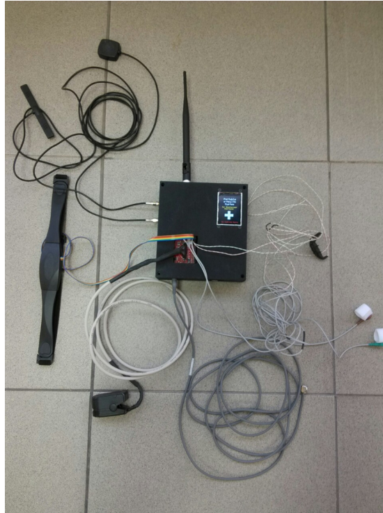
Fig. 43: Montaje dentro de la carcasa con sensores
