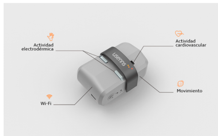
Figura 2.4: Anillo de Usenns. En la figura podemos observar el sensor de actividad cardiovascular (BVP), que se sitúa en la primera falange del dedo índice, el de actividad electrodermica de la piel (GSR), cuyos electrodos se posicionan sobre las segundas falanges de los dedos índice y corazón, y el acelerómetro o sensor de movimiento. Además, incorpora un módulo Wi-Fi para el envío de datos.
