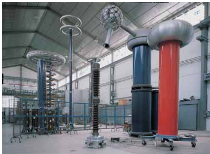
Test de rutina a Transformador de tensión de 245 kV.
