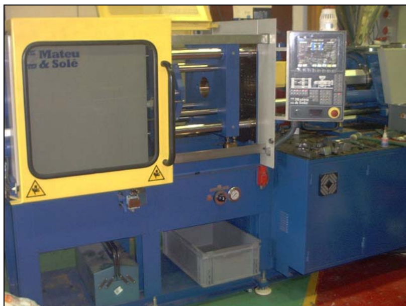
Imagen de la máquina de inyección utilizada para realizar los ensayos
