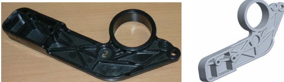
Fig. Pieza encargada de abrir un contenedor 2400 y su modelo diseñado en ProEngineer
