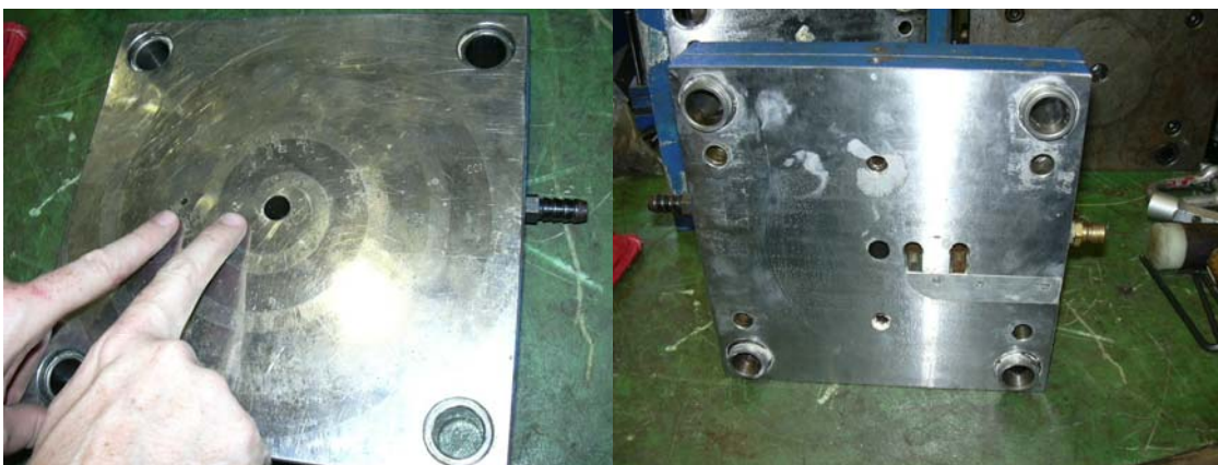
Fig. Imagen de los sensores 1 y 3 en el molde espiral.
