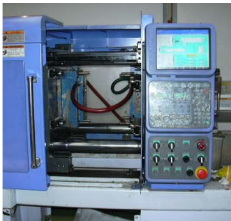
Fig. Molde colocado en la máquina de inyección (imagen a la izquierda) y detalle ampliado del molde en la máquina (imagen a la derecha)
