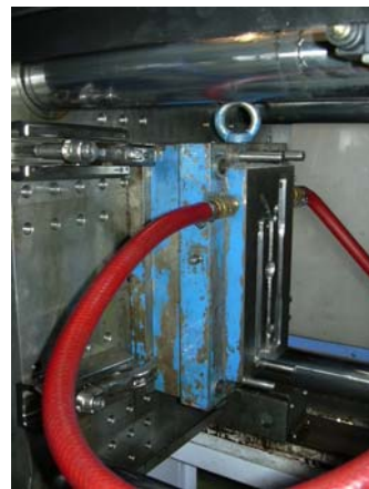
Fig. Molde colocado en la máquina de inyección (imagen a la izquierda) y detalle ampliado del molde en la máquina (imagen a la derecha)
