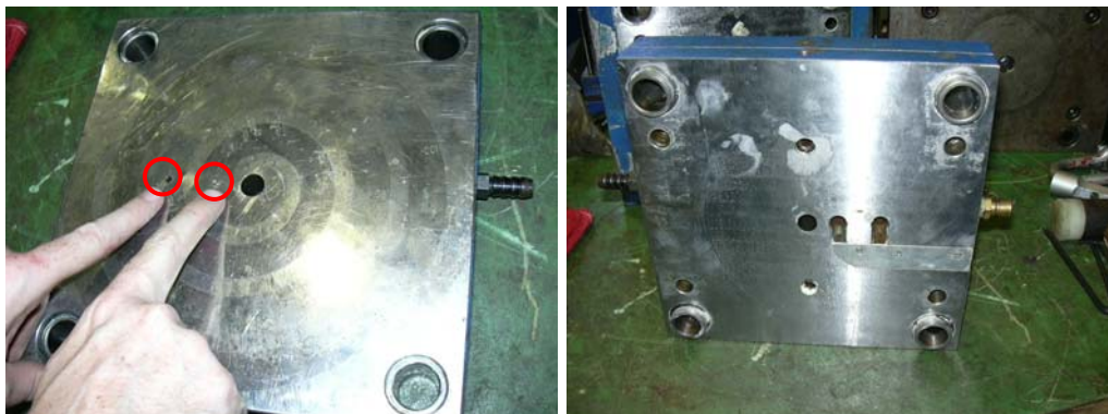
Fig. Posición inicial de los sensores de presión.
