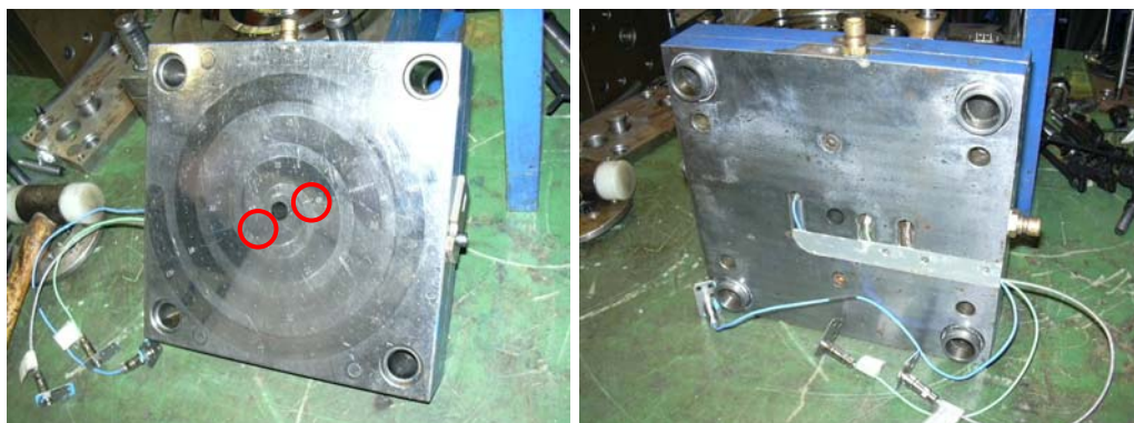
Fig. Nueva posición para el segundo sensor de presión
