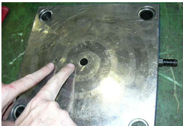
Fig. Situación de los sensores de presión en el molde espiral.
