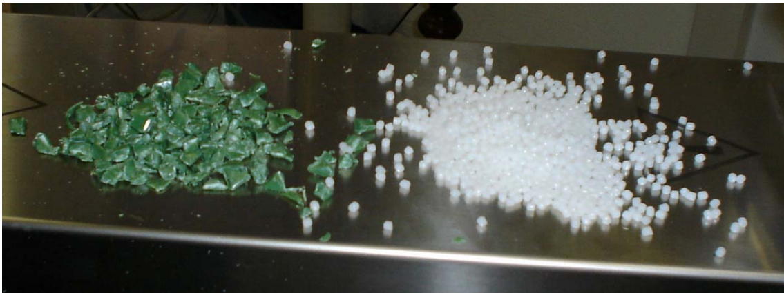
Fig. Material reciclado y material virgen analizado en el reómetro de placas.
