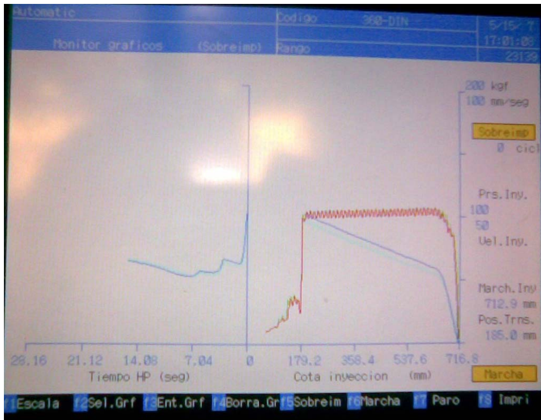
Fig. Gráfica de inyección obtenida de los monitores de control de la máquina de inyección.
