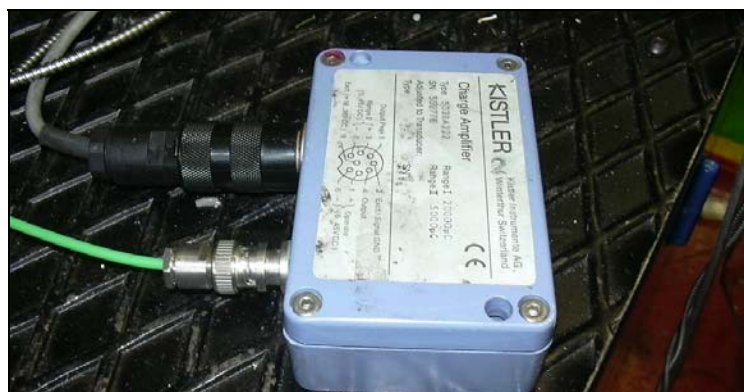
Fig. Amplificador con los cables de entrada y salida de señal.
