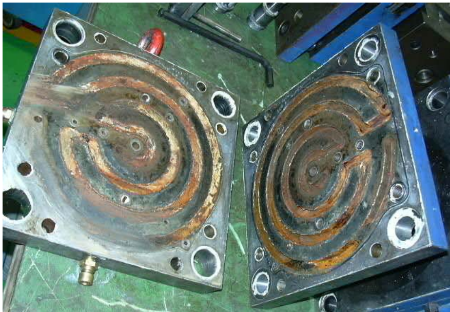
Fig. Refrigeración del molde. Ancho del canal 11mm.
