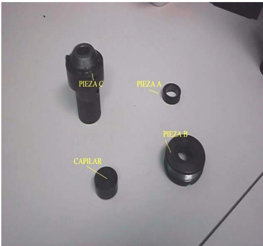
Fig. Capilar y piezas de montaje
