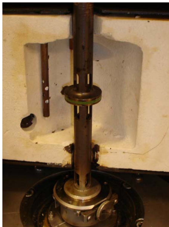
Fig. Reómetro de placas de 25mm.
