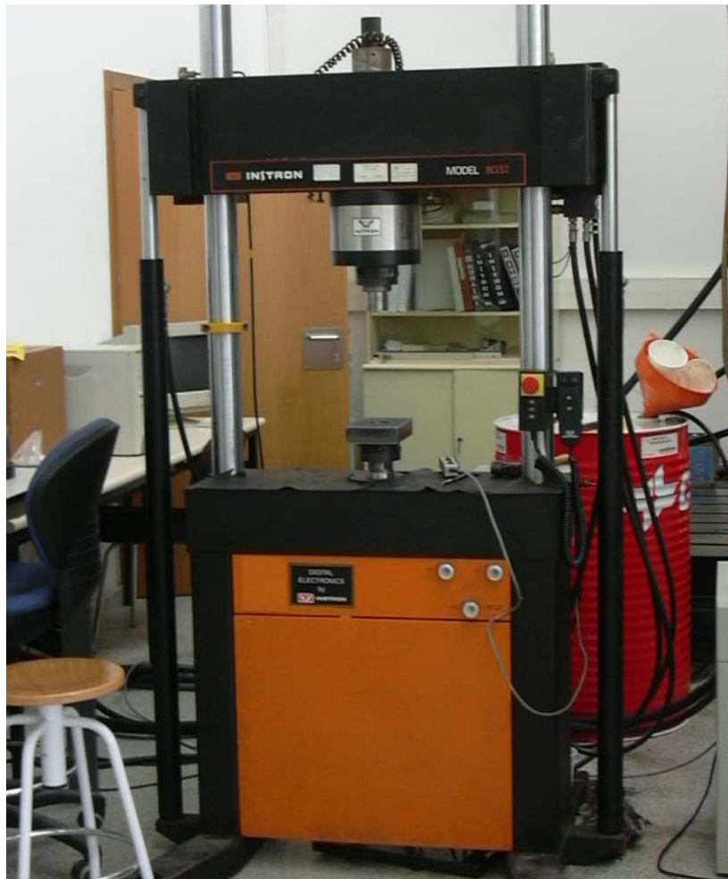
Fig. Máquina de ensayos universales Instron 8032
