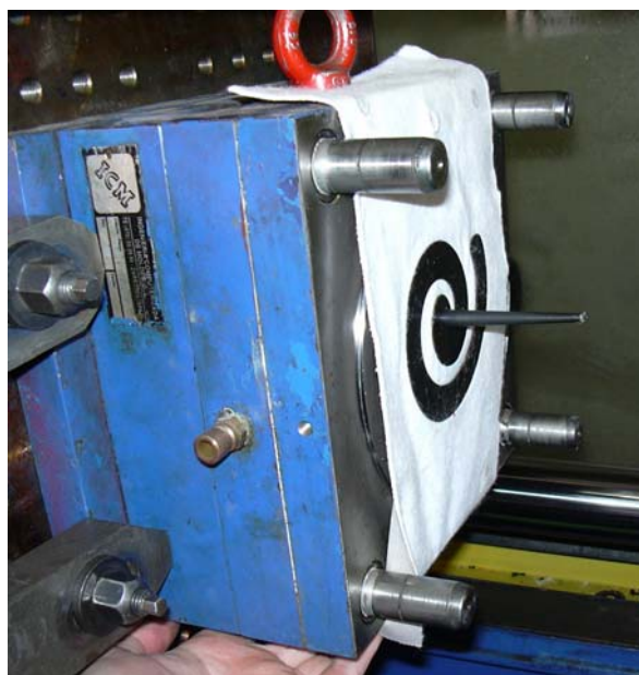
Fig. Inyección de la espiral de plástico sobre el film.
