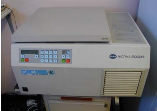
Figura 27. Centrifugadora Mistral 2000R usada para centrifugar la sangre y separar los elementos formes del suero.
