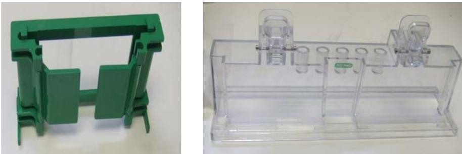
Figura 41. Soporte de biorad® en el que se colocan 2 cristales y entre ambos se solidificará el gel, por separado y antes de su montaje.
