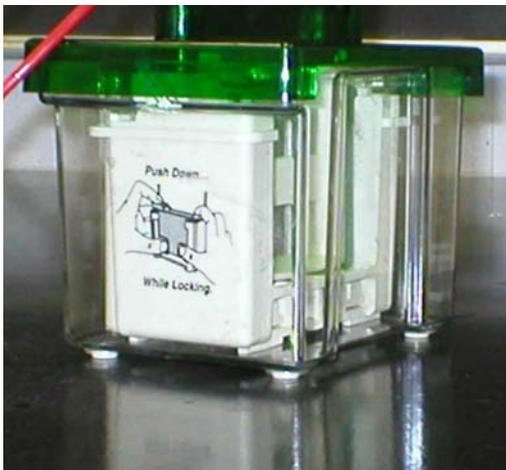
Figura 43. BioRad Mini Protean 3 con la tapa que presenta dos electrodos para la fuente de alimentación.
