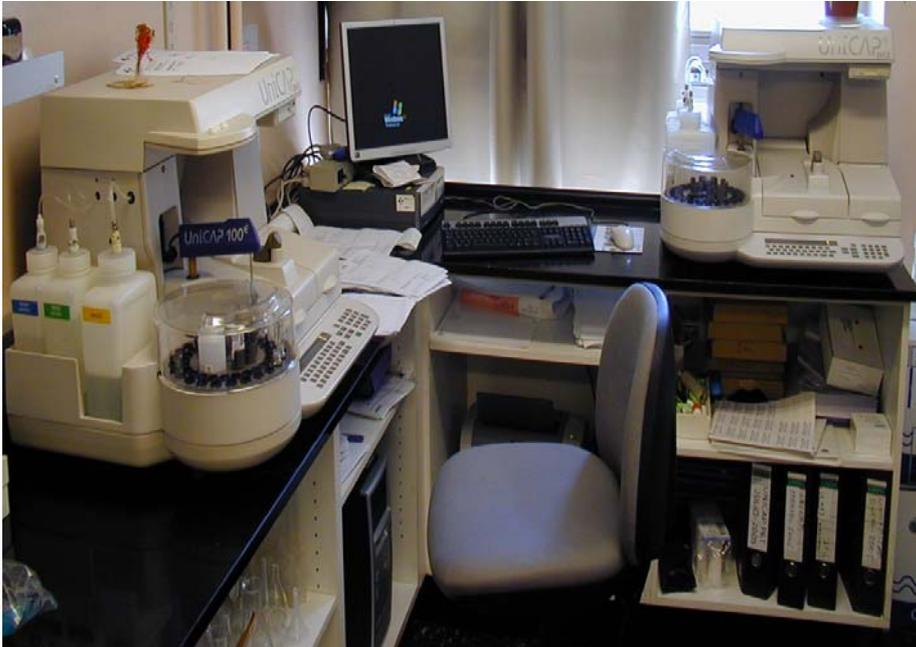
Figura 35. Obsérvese 2 aparatos UniCap®100 conectados a un ordenador y una impresora para procesar e imprimir los resultados.
