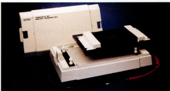
Figura 51. Semi-Dry blotting usado para transferir las proteínas del gel a la membrana de nitrocelulosa.
