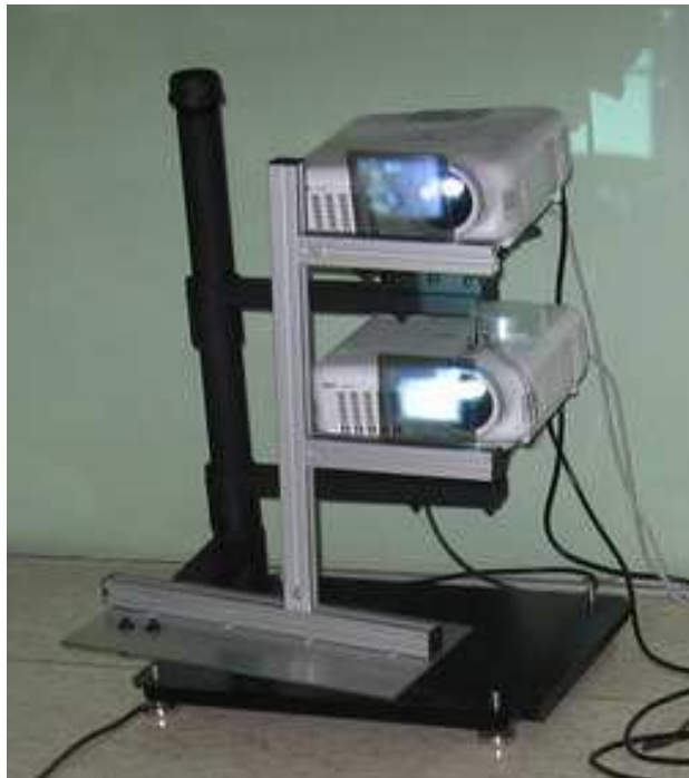
Figura D.8: Proyectores con filtros polarizadores y soporte.
