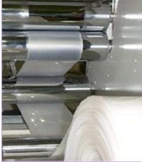
Figura 1.6: Proceso de calandrado [67].
