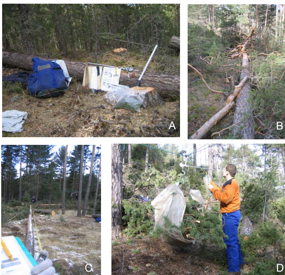
Figura 2.3. A) Materiales utilizados en el trabajo de campo; B) pie arbóreo apeado desramado y despuntado; C) medición de la altura posterior al apeo; D) pesada de la biomasa en húmedo
