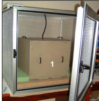
Figura. 3.12.- Instalación experimental formada por una cámara de mumetal (1). Con esta configuración se logra reducir la contaminación electromagnética ambiental. Los valores de las componentes continua y variable del CM en el interior ( 0.24 y 0.14 \mu\text{T} ) y el exterior ( 30.28 y 0.30 \mu\text{T} ) respectivamente, muestran que el grado de apantallamiento es mayor para la componente estática.
