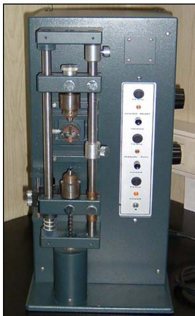
Figura 3.4.- Estirador de microelectrodos. Variando los parámetros de temperatura del filamento y solenoide se obtienen los electrodos con las formas de punta y resistencias adecuadas para la realización de los registros electrofisiológicos.
