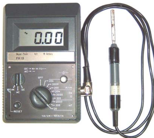
Figura 3.9.- Sonda de efecto Hall utilizada en la calibración del campo magnético alterno generado por las bobinas de Helmholtz.
