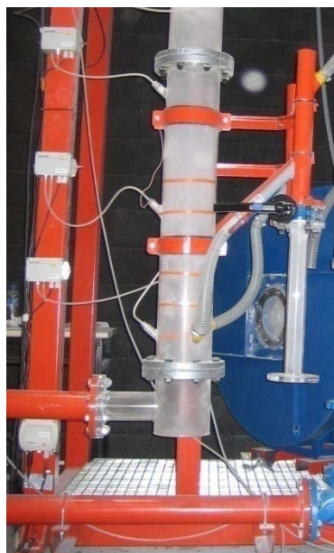
Figura 12. Lecho fluido circulante del circuito de carbonatación.
