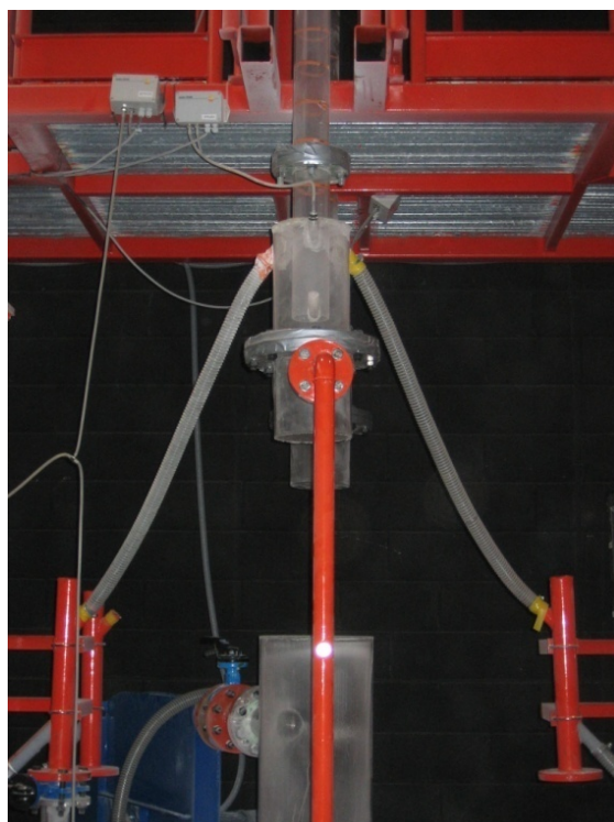
Figura 16. Conexiones de las loopseals de los circuito de carbonatación y calcinación.
