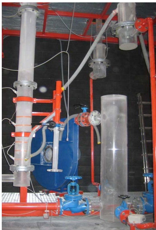
Figura 22. Conexión de la loopseal con el lecho fluido circulante del circuito de carbonatación.
