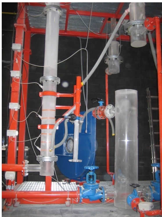
Figura 17. Conexiones de la loopseal del circuito de carbonatación.
