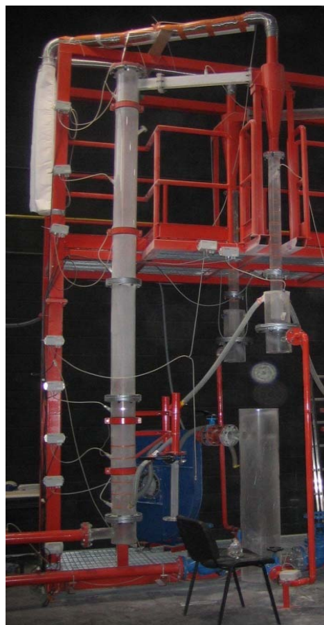
Figura 23. Configuración del circuito de carbonatación de la instalación.
