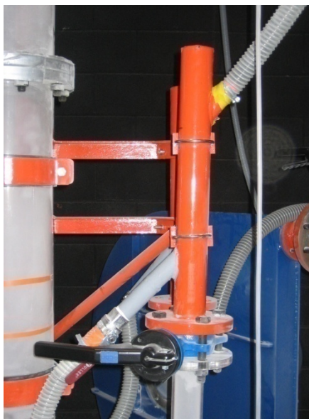
Figura 20. Válvula de mariposa (Tipo: cuarto de giro).
