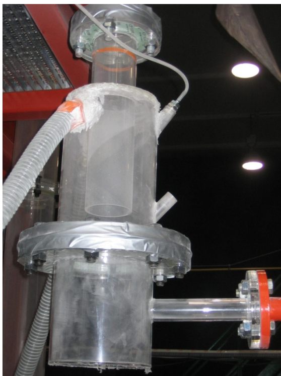
Figura 15. Loopseal del circuito de carbonatación.
