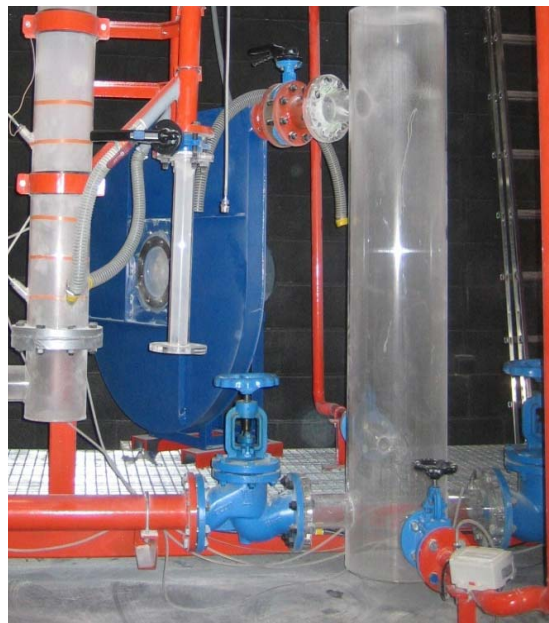
Figura 11. Conjunto de válvulas del circuito de carbonatación.
