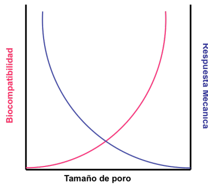
Figura 7: Tamaño de poro versus biocompatibilidad versus respuesta mecánica.
