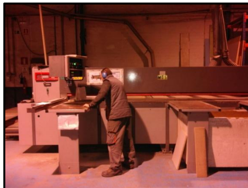
Operario trabajando en la seccionadora
