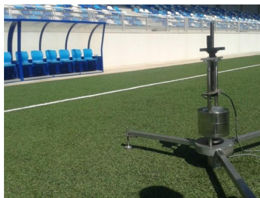
Figura 4. Atleta mecánico para la valoración de absorción de impacto y restitución energética.
