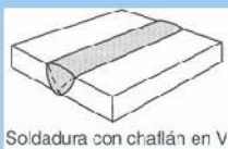
Soldadura con chaflán en V
