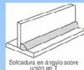
Soldadura en ángulo sobre unión en T
