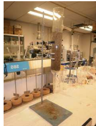
Figura 4.2: Filtro de arena.
