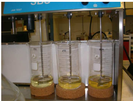
Figura 4.1: Jar Test para el ensayo de precipitación química.
