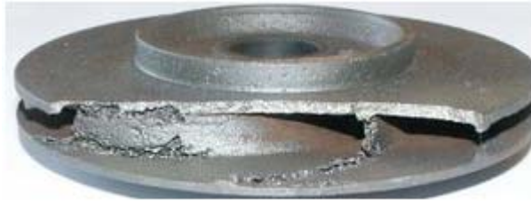
Figura 3.3. Desgaste producido por la cavitación en un rodete de una bomba centrífuga.
