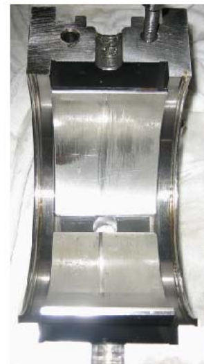
Figura 2.26. Casquillo dañado con marcas de roce metal-metal
