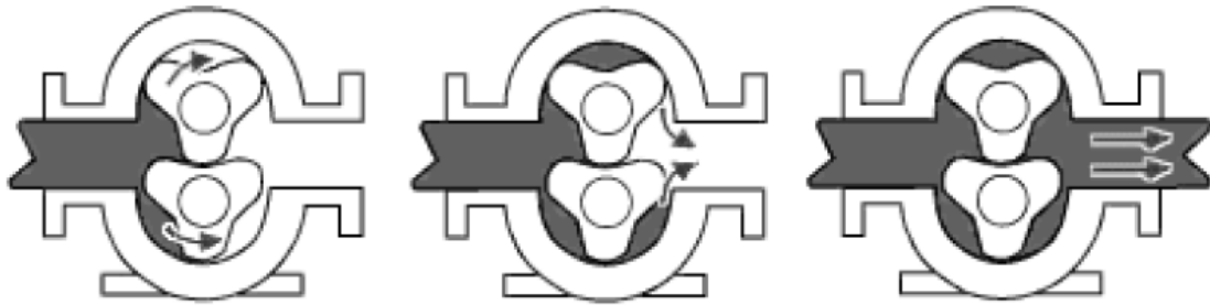
Figura 4.6. Esquema de funcionamiento de una bomba de lóbulos externos.
