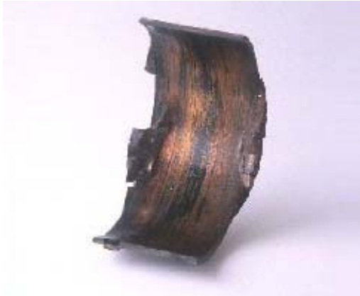
Figura 2.27. Casquillo dañado por lubricación deficiente.
