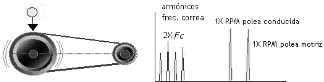
Figura 2.55. Fenómeno y espectro vibratorio de una correa destensada.
