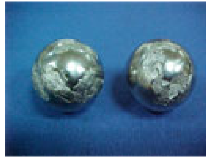
Figura 2.48. Bolas dañadas por ácidos
