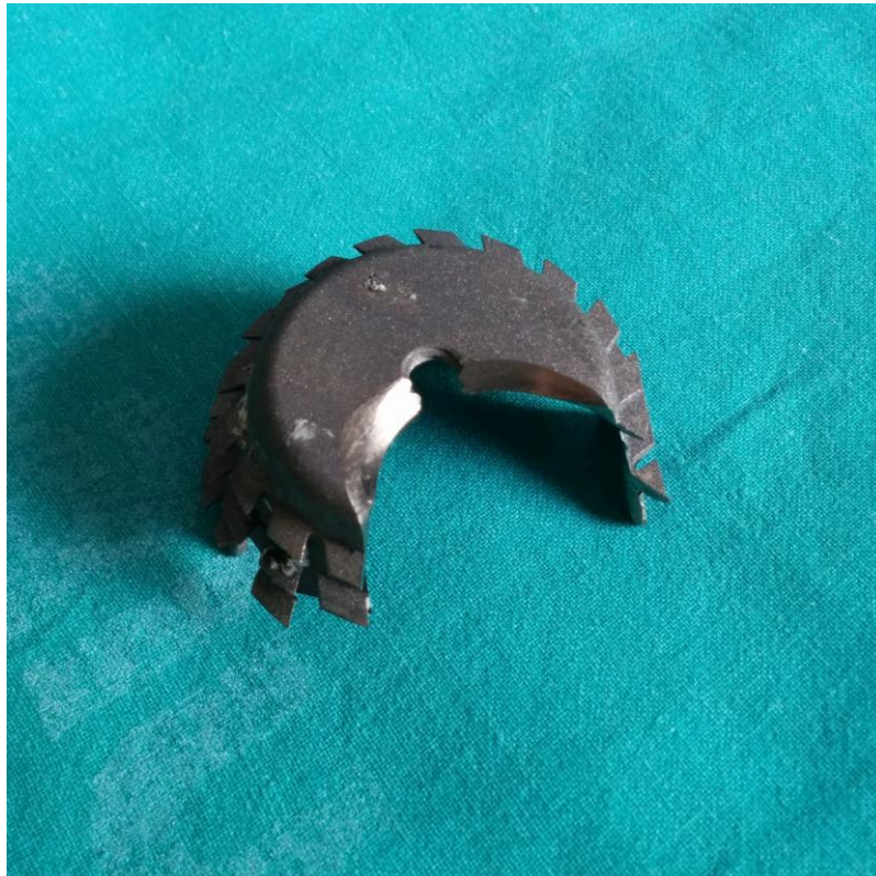
Figura 33 y 34: Piezas obtenidas la paciente del caso de la figura 31 B en el que se objetivó rotura del implante y polietileno con pulido de los bordes.
