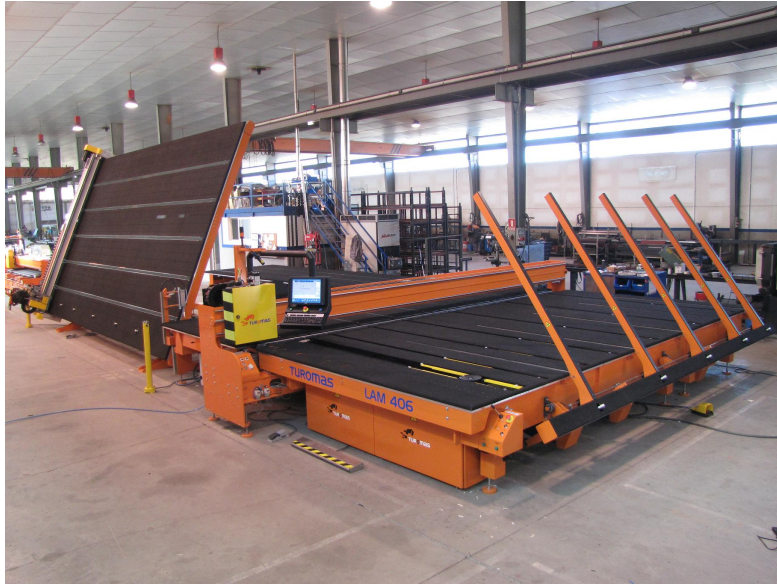
Figura 4.20: Máquina de corte de vidrio monolítico y laminado (Cortesía de TURROMAS)
