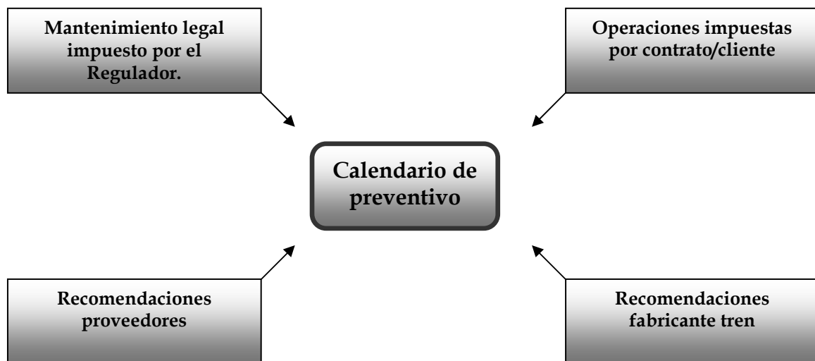
Figura 4.3. :Diagrama de las diferentes fuentes condicionantes a para confeccionar un plan de mantenimiento preventivo. Fuente: Elaboración propia
