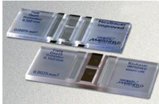
Fig. 16. Cámaras de Neubauer mejoradas , en la inferior se puede apreciar la suspensión celular con Trypan Blue en sedas reticuladas
