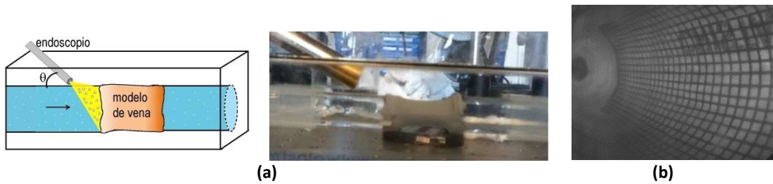
Figura 3.39. Modelo de vaso y endoscopio inmersos en líquido de índice. (a) Esquema y foto. (b) Vena de silicona revestida con papel milimetrado.
