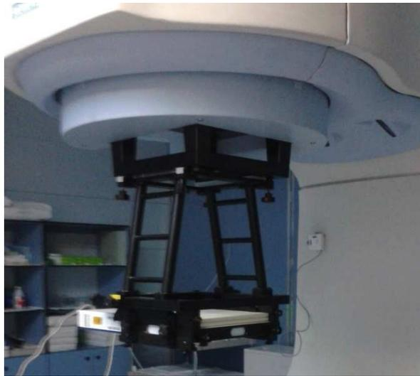
Figura 3.6.- Detector MatriXX acoplado al acelerador con un soporte de desplazamiento milimétrico. Se observa el sensor de ángulos acoplado al brazo y un espesor de acumulación de 2 cm colocado sobre el detector.
