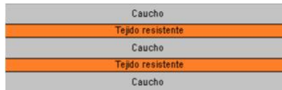
Figura B-1- Capas de material de un dique inflable
