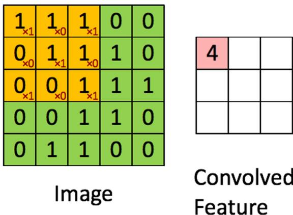
Esquema del modo de funcionamiento de la capa convolucional en imágenes. [8]
