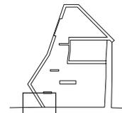
Prolongación de la envolvente hasta el pavimento, sin entrar en contacto.
