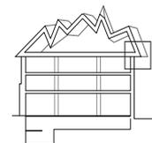
Ruptura de la continuidad al cambiar el material de la piel exterior en el plano inferior.
