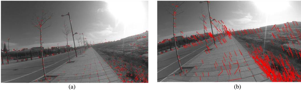
**Figura 4.4.** Flujo óptico cuando el corredor pasa por su eje vertical (a), cuando da un paso (b).
