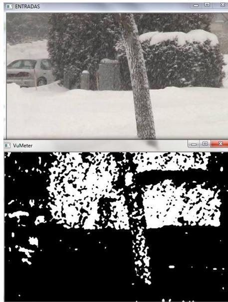
**Figura 10:** Ejemplo de problemas generados en fondos dinámicos (para el método de VuMeter, uno de los más afectados).
