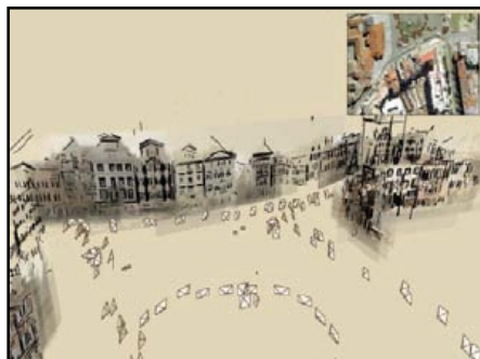
Ilustración 2: Reconstrucción en nube de puntos (Structure From Motion) (Snavely, Seitz, & Szeliski, 2006)
