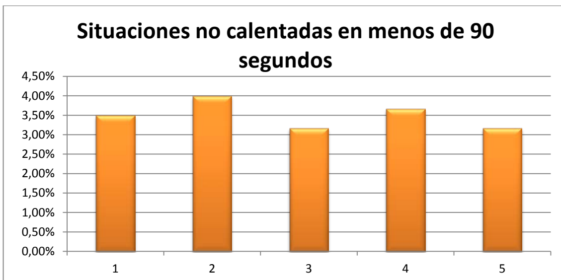
Figura 27. Número de situaciones en que no se ha podido calentar todos los recipientes en un tiempo inferior a 90 segundos, expresado en tanto por ciento del número de situaciones evaluadas
