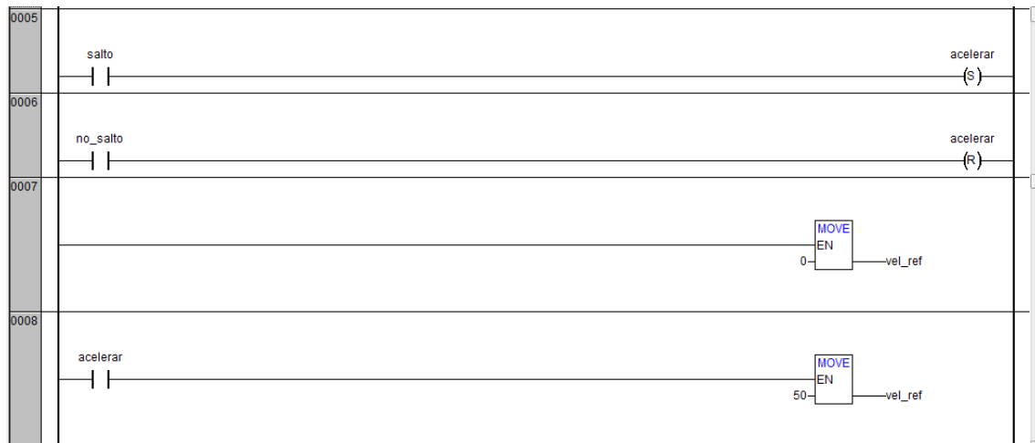
Figura 3.2.3 d): Programa control vectorial en CoDeSys 4: Generar referencia.
