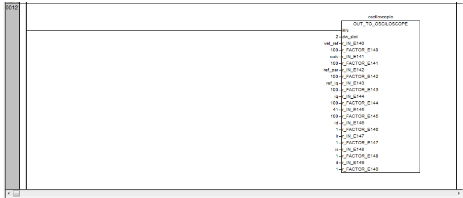
Figura 3.2.3 h): Programa control vectorial en CoDeSys 8: Escribir en memoria para representar gráficamente.
