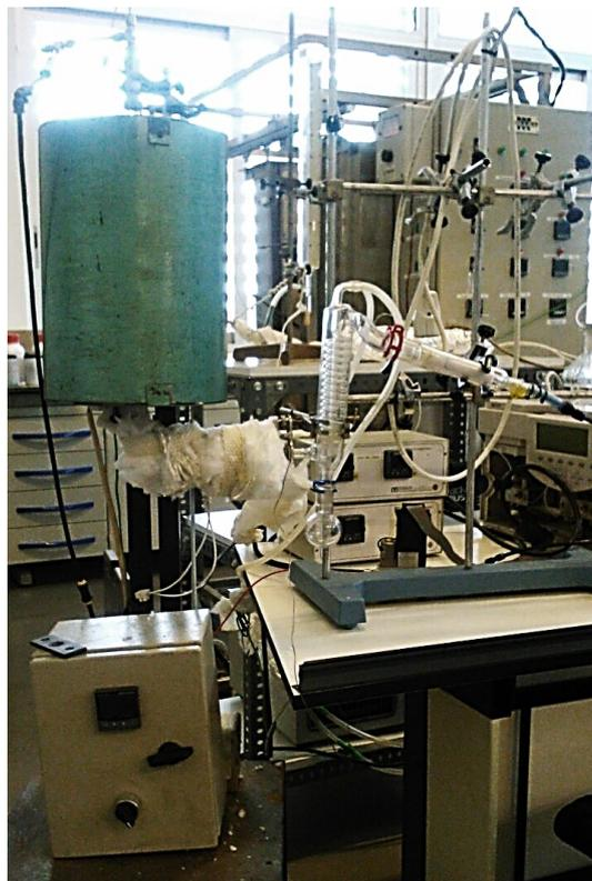
Figura 6-7. Instalación experimental de pirólisis.
