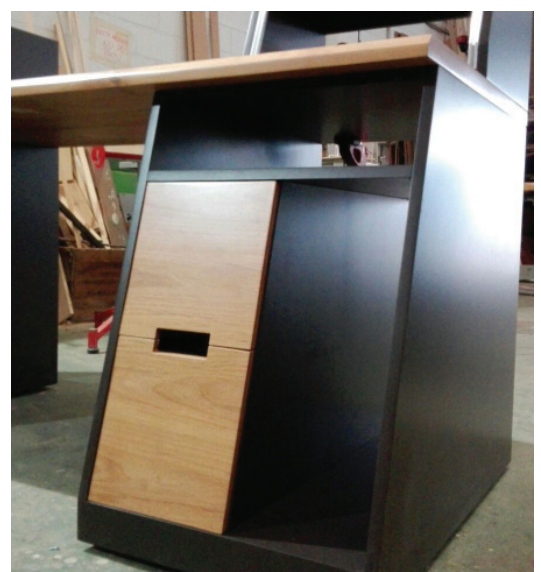
Para dotar de mayor calidad y resistencia al mueble se decide fabricar los frontales de los cajones en el mismo material que el sobre, arce natural barnizado.
