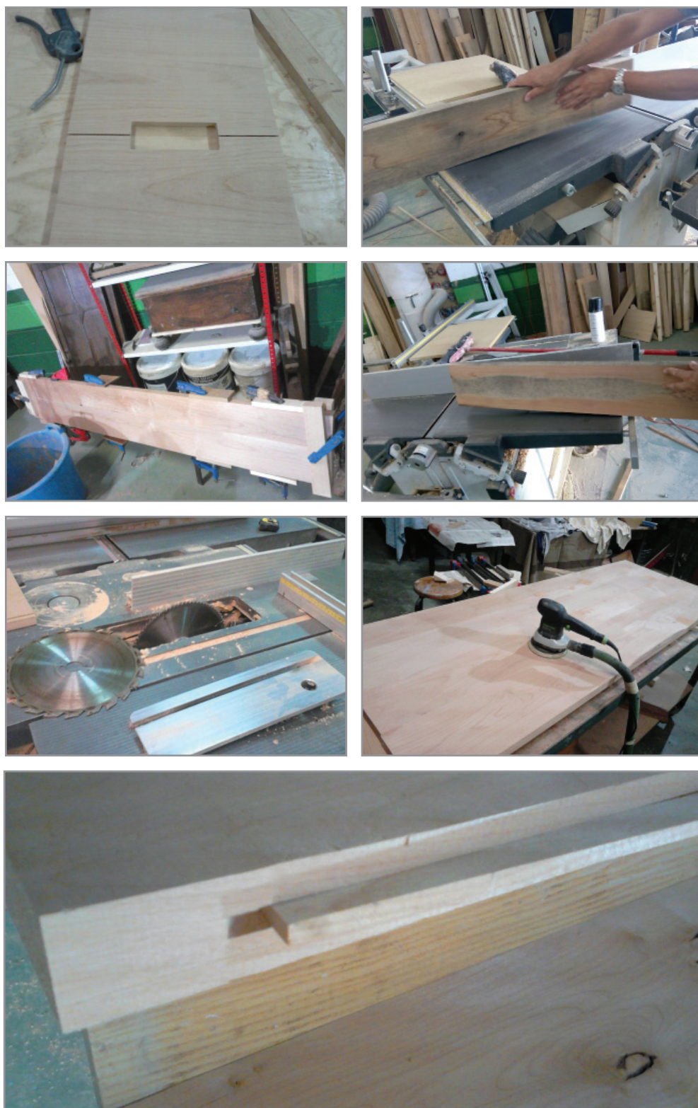
Evolución en la fabricación de cada una de las piezas en el taller de carpintería.
