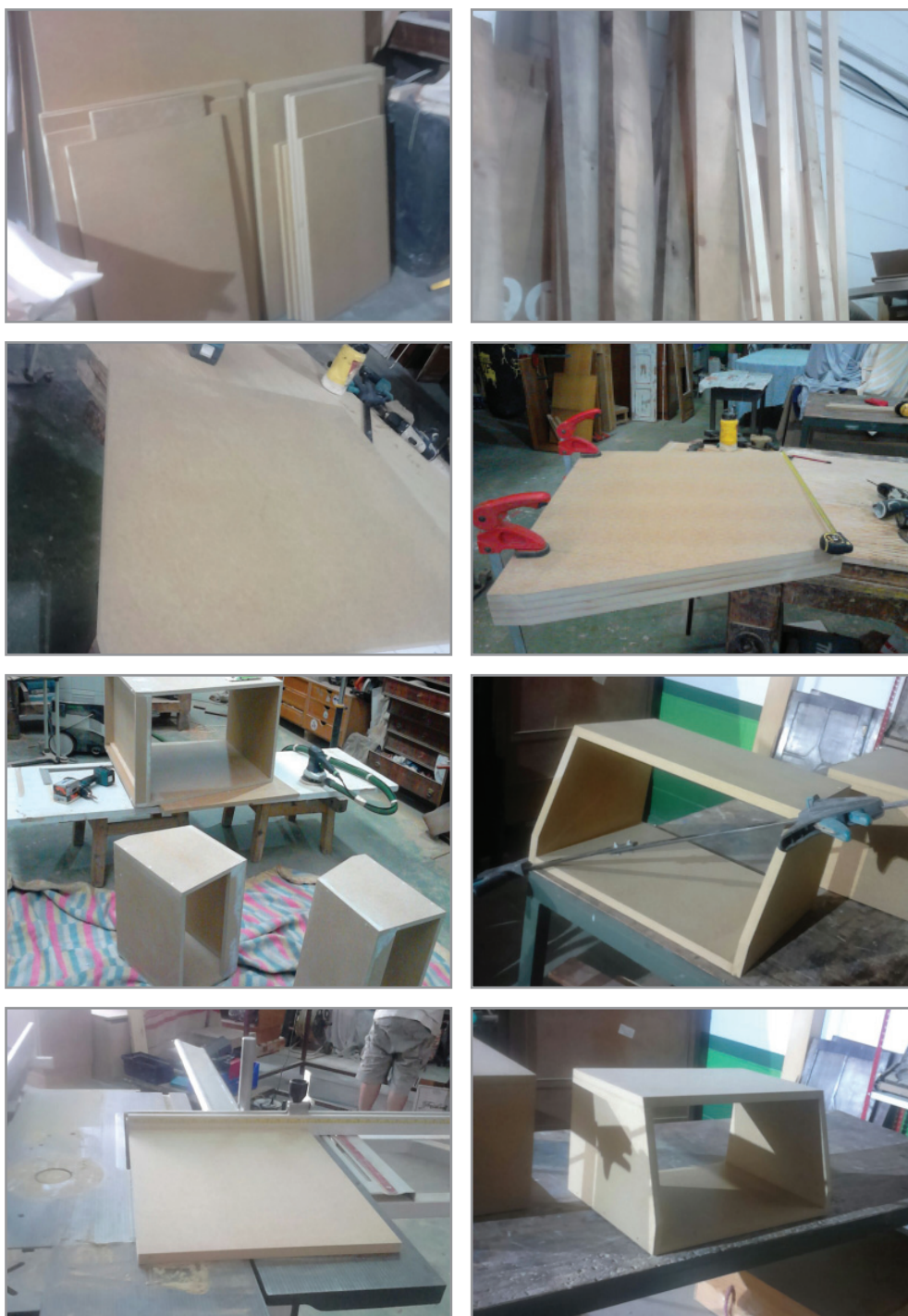
Evolución en la fabricación de cada una de las piezas en el taller de carpintería.
