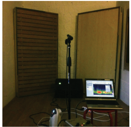
Sin mover los absorbentes y con el altavoz en medio de ambos, ubicamos el micrófono en la posición prevista del técnico dentro de la sala, en su puesto de trabajo.
