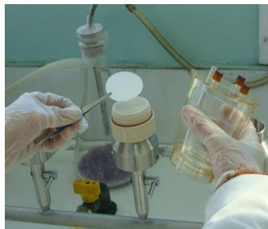
Ubicación filtro en copa filtración
