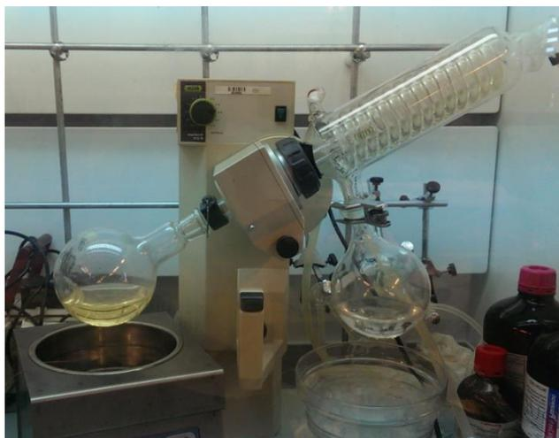
**Figura 3.3** Sistema de obtención de ciclopentadieno.
