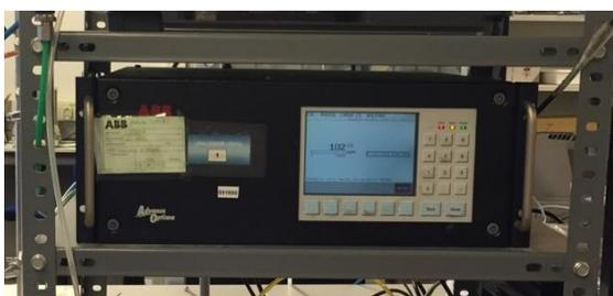
**Figura A.12** Analizador de CO y  $\text{CO}_2$ .
