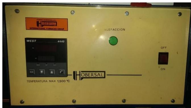
**Figura A.9** Sistema de control del horno eléctrico.
