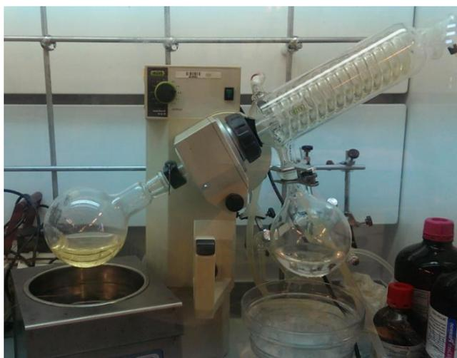
**Figura A.1** Sistema experimental para la obtención del ciclopentadieno a partir de su dímero.
