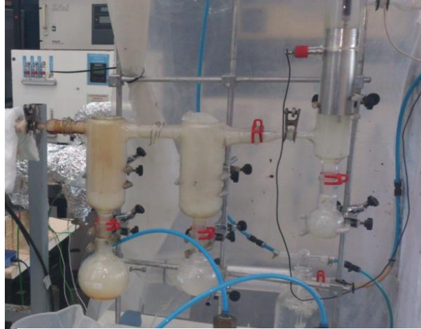
Figura 6. Sistema de recogida de condensados
