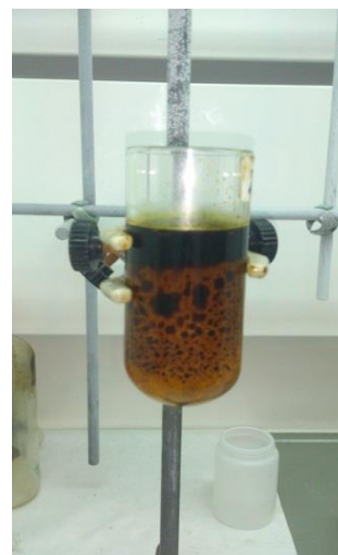
Figura 15. Distribución de fases a 550 °C
