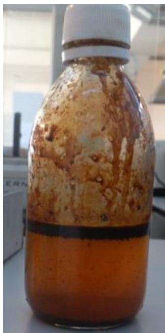
Figura 14. Distribución de fases a 350 °C
