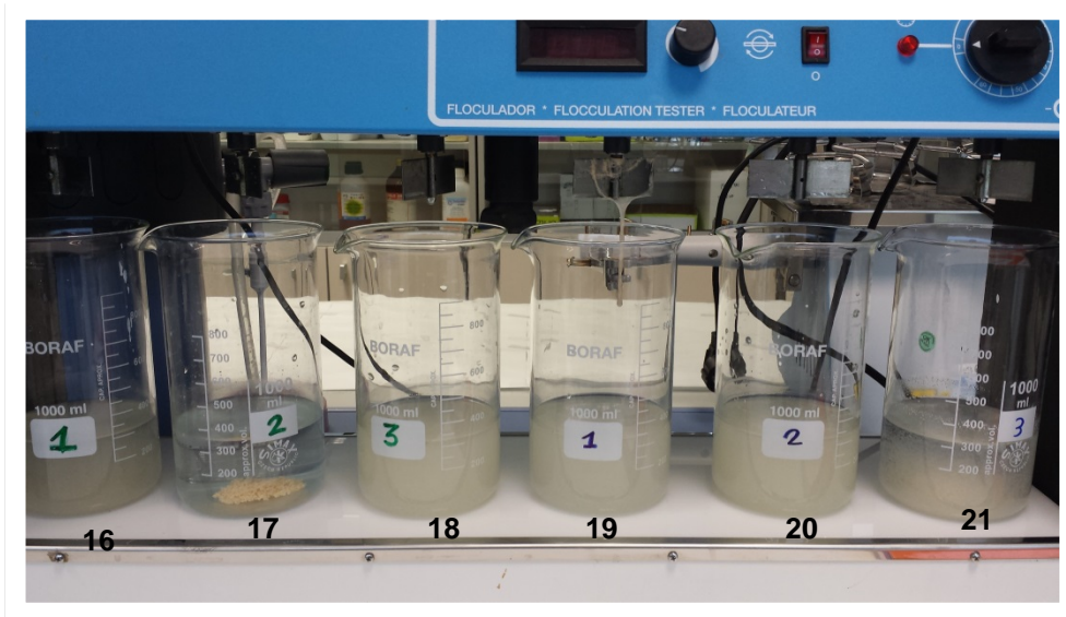
Figura 3.5. Ensayos con diversas combinación de coagulante y polielectrolito con cal.
