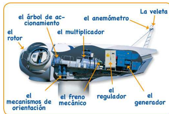
IMAGEN 1: PARTES AEROGENERADOR
