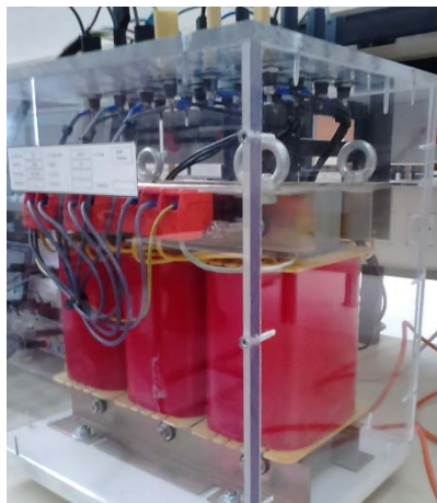
Imagen 10. Transformador entrenador trifásico.
