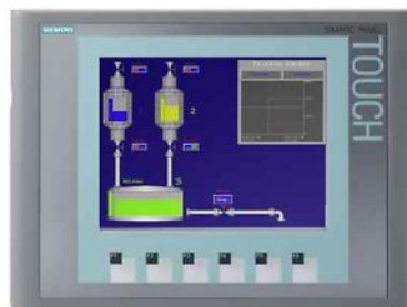
Imagen 8. HMI KTP600 Basic color PN. Siemens.
