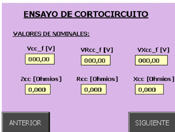
Imagen 29. Resultado del ensayo de cortocircuito. Valores nominales. HMI.
