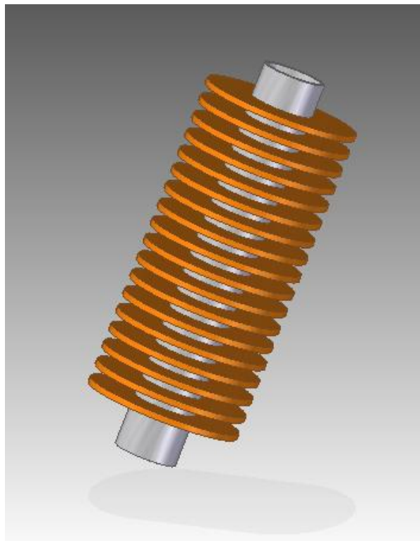
Figura2.5: Tubo aleteado (18 aletas)
