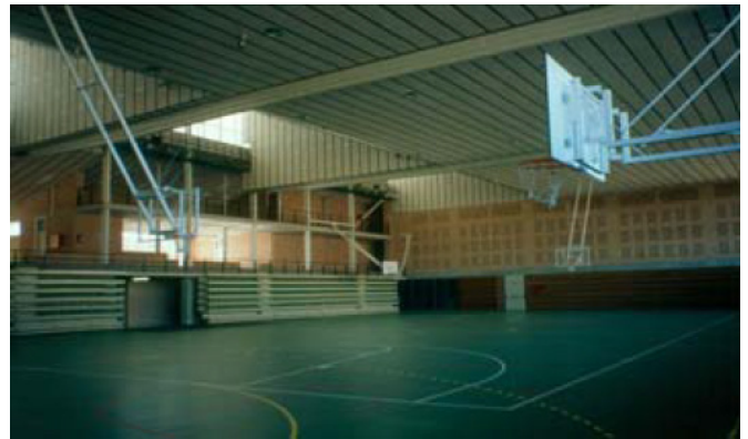
4_20 Pabellón con paneles acústicos en las paredes.
