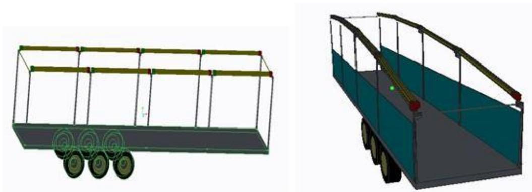
*Ilustración 5. Figura 5- izda, y 5- dcha, caja de geometría variable para semirremolque. Las figuras muestran dos configuraciones distintas.*
