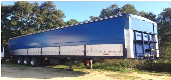
*Ilustración 10. Semirremolque de semilonas. [www.mitrailer.com](http://www.mitrailer.com)*
