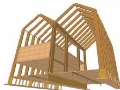
I. 40 Modelo de cálculo usado en su fase de diseño
