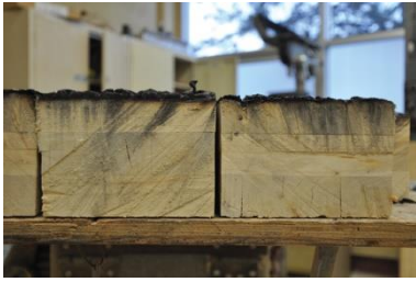
I. 23 Estado de unos paneles de CLT tras un test de incendios
