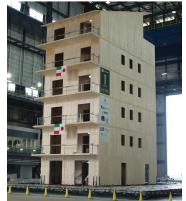
I. 26 Ensayo sísmico de un edificio entero realizado con CLT. Japón
