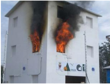
I. 24 Test realizado con un edificio de 3 plantas construido íntegramente con estructura CLT. Realizado en el Building Research Institute in Tsukuba in Japan
