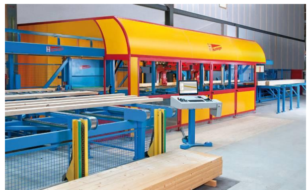
I. 18 Máquina de corte por control numérico usada por Jesfer
