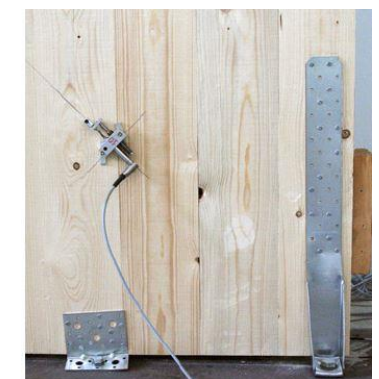
I. 28 Patologías generada tras un test sísmico
