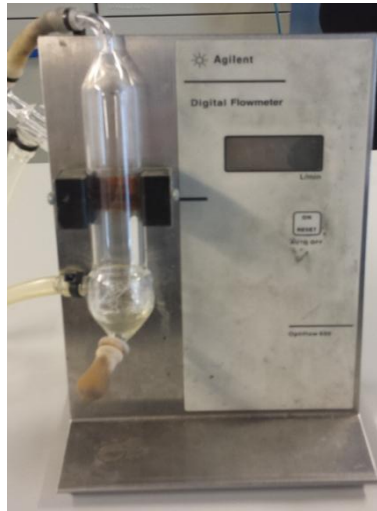
Figura A.4. Medidor de caudal volumétrico digital
