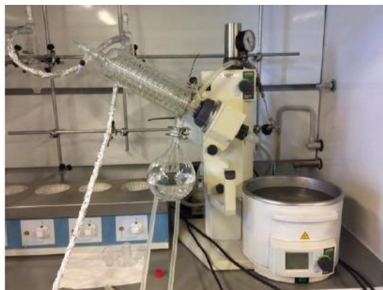
Figura B.2. Imagen del rotavapor en el proceso de concentrado de muestras
