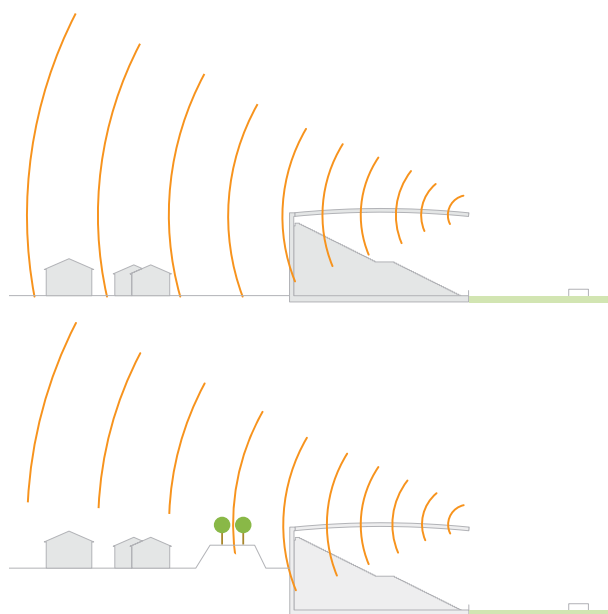
[4.05] Esquema del problema tipo (superior) y solución (inferior) para reducir el impacto acústico de un estadio.
