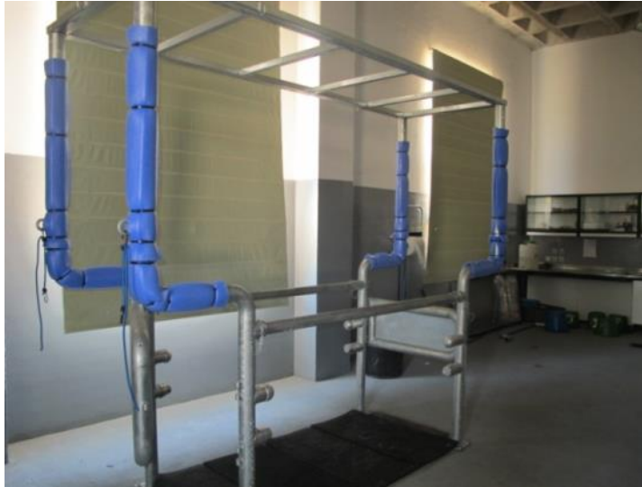
Figura 2.19. Potro de contención del HVUZ, especialmente diseñado para cirugía laparoscópica en estación.
