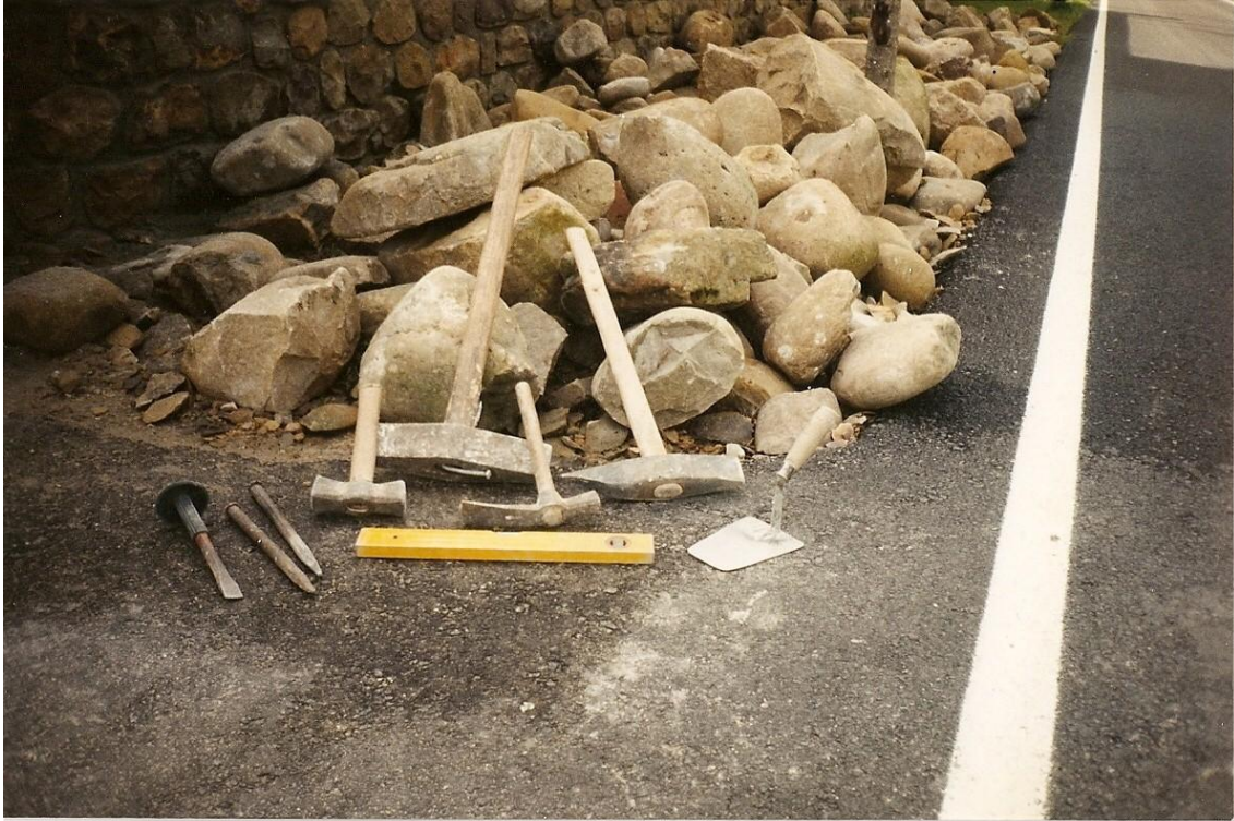
9-Cinzel, puntero, maceta, mallo, piqueta, martillo, paleta y nivel de burbuja. Penilla de Toranzo (1998).
