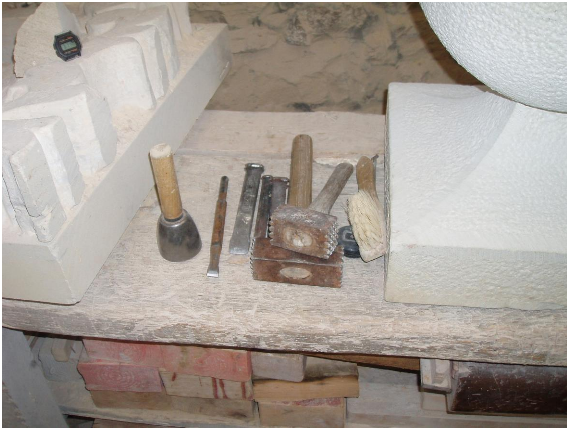
11-(Arriba) Maceta de campana, cinceles, bujardas y cepillo. Alceda. 12-(Abajo) Gonzalo Ruiz con una bota de pintar líneas. San Vicente de Toranzo.
