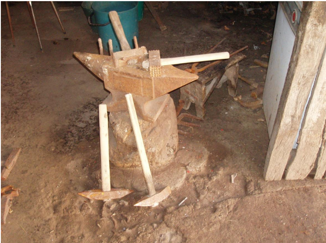
7-(Arriba) Losa de la India. El Soto. 8-(Abajo) Bujardas sobre yunque de herrero y martillos. Sel del Tojo.
